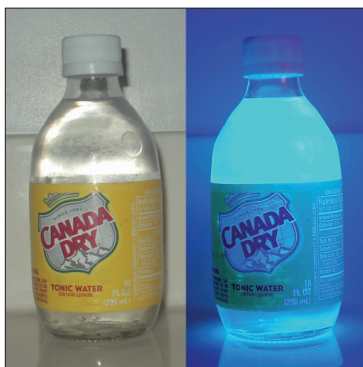
Obr. 7 Tonik s obsahem chininu pod UV světlem, kde fluoreskuje (převzato z: http://en.wikipedia.org/wiki/Tonic_water )
