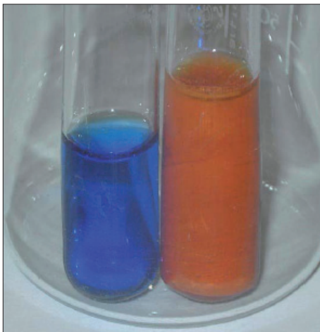
Obr. 2 Reakce glukózy s Fehlingovým činidlem (vlevo před, vpravo po reakci) (převzato z: http://www.chempok.wz.cz/ , Martin Hrubý, Zajímavé chemické pokusy)
